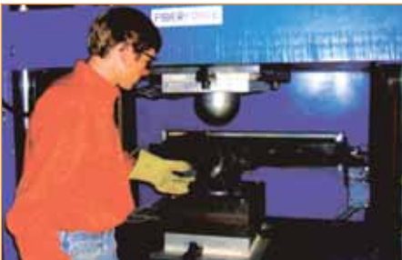
Slika 37: "Tancanje" organoplo-evine za telo avtomobila s ciklusom 45 s
