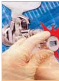
Slika 79: Digitalni manometer s točnostjo 0,05 bara doprinese k natančni debelini in barvnemu tonu pri lakiranju
