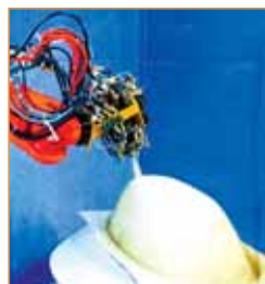
Slika 35: Stranska oja-itev kopalne kadi s postopkom PUR-CSM
