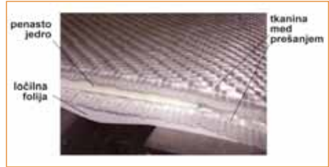
Slika 38: Zgradba sendviča pred impregniranjem
