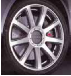
Slika 58: Audi A8 - poželji (keramične zavore imajo 4-kratno življenjsko dobo)
