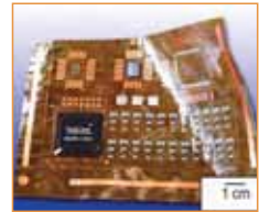
Slika 51: Proizvodnja fleksibilnih vezij - veze na PEEK foliji
